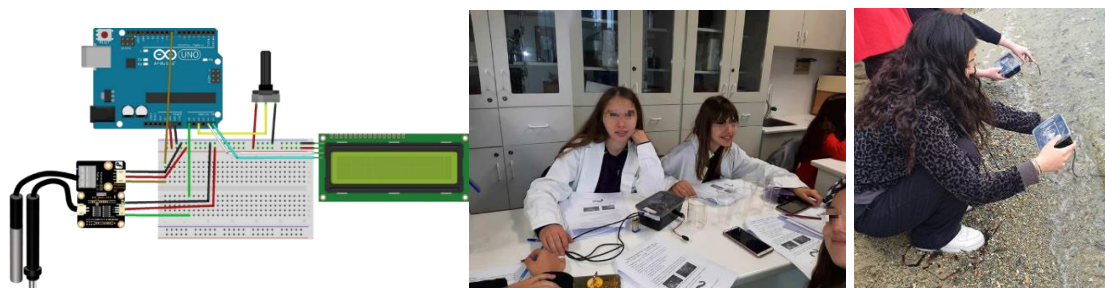
Σχήμα 1. Εργαστηριακό όργανο μέτρησης της αλατότητας θαλασσινού νερού
